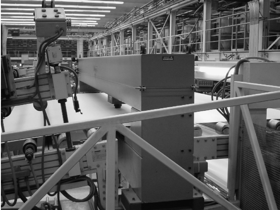
DAC Hovercraft an einer Freischaumanlage
